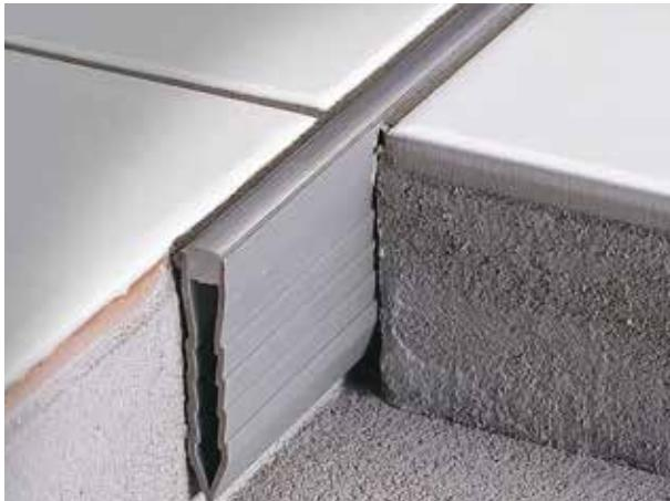
Juntas de fraccionamiento de material sintético para colocación con mortero. Diseñadas para dividir grandes áreas de baldosas en áreas más pequeñas, ofrecen una protección limitada en el borde del pavimento. Compensan pequeños movimientos debidos a la dilatación de los materiales de soporte, pero exclusivamente en compresión o deslizamiento. Situación de aplicaciones típicas: tiendas, áreas recreativas como hoteles, centros deportivos y escuelas.
